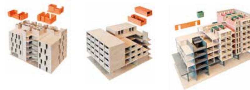
Vorgefertigte, individuelle Raummodule von Kaufmann Bausysteme
